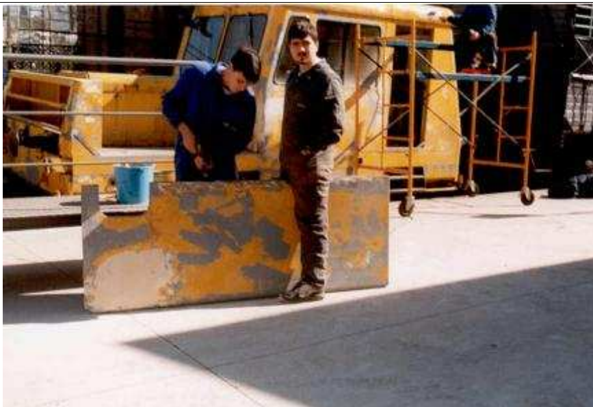
Saneamiento del perfil del lateral izquierdo
