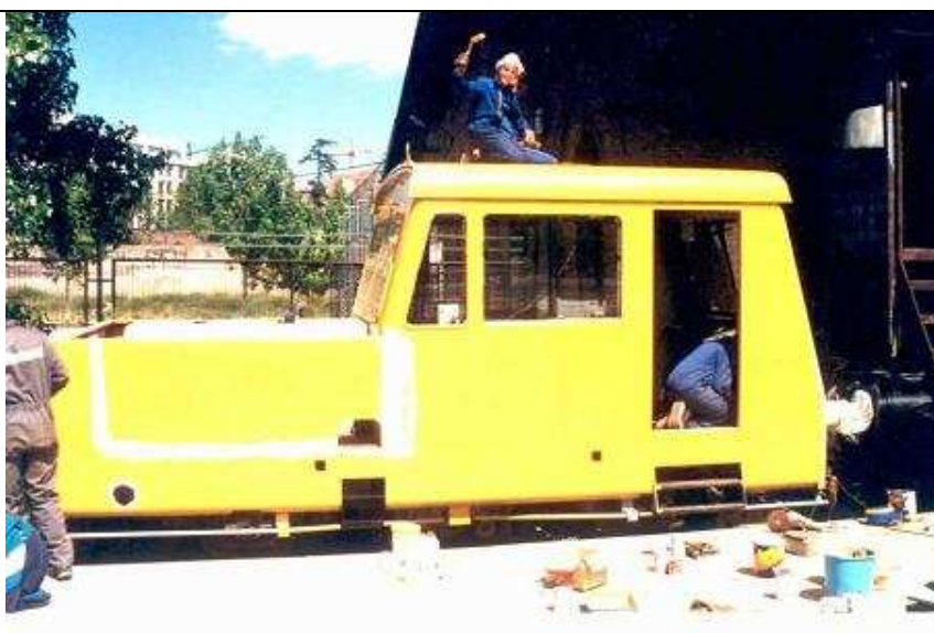
Finalizando la primera mano de pintura
